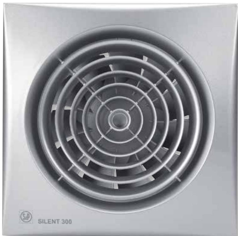
Вентиляторы SILENT-300 изготавливаются из высококачественного пластика, комплектуются обратным клапаном и однофазным электродвигателем (230В-50Гц), класс изоляции В, со встроенной термозащитой. Электродвигатель крепится к корпусу при помощи резиновых "сайлент-блоков", которые предотвращают передачу вибраций на корпус вентилятора.
