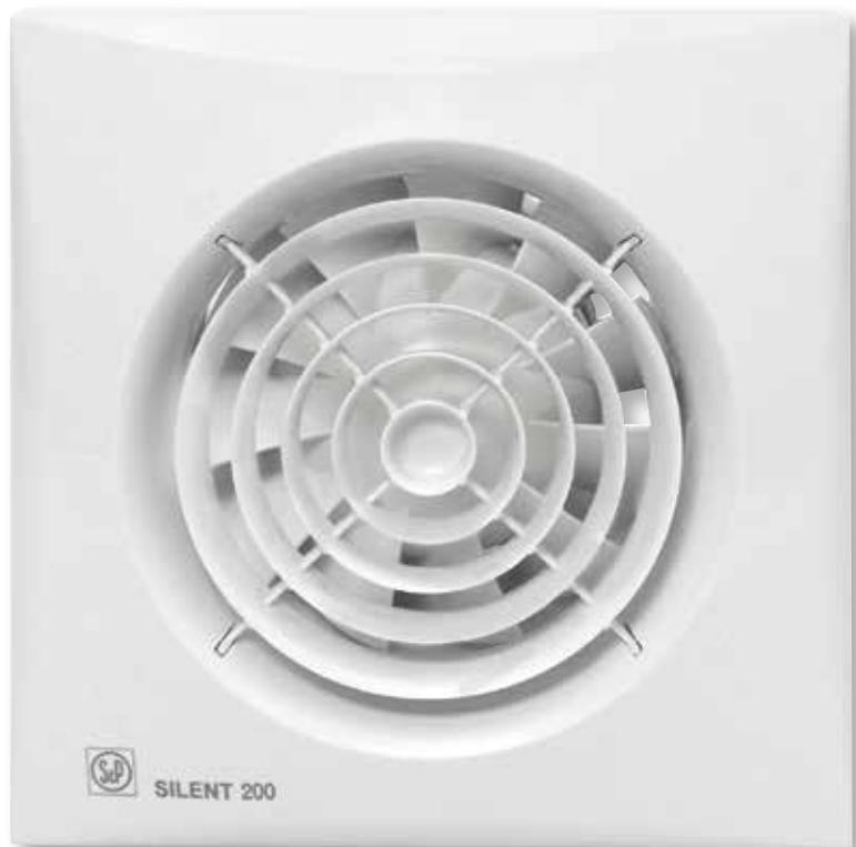
Вентиляторы SILENT-200 изготавливаются из высококачественного пластика, комплектуются обратным клапаном и однофазным электродвигателем (230В-50Гц), класс изоляции В, со встроенной термозащитой. Электродвигатель крепится к корпусу при помощи резиновых "сайлент-блоков", которые предотвращают передачу вибраций на корпус вентилятора.
