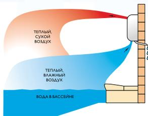
Базовые модели осушителей предназначены для установки непосредственно в помещении бассейна.
