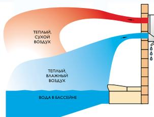
Осушители TTW предназначены для установки в смежном с бассейном техническом помещении. Такое расположение осушителя позволяет сохранить дизайн помещения бассейна, в котором устанавливаются только декоративные решетки забора и подачи воздуха.
