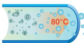
Нагрев воды в баке до температуры 70°C уничтожает большую часть бактерий, находящихся в водопроводной воде. Бак изготовлен из нержавеющей стали и не подвержен коррозии.
