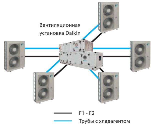
Система обеспечения свежего воздуха от Daikin обеспечивает комплексное и удобное решение, включая вентиляционную установку, конденсаторный блок ERQ или VRV, а также все средства управления установкой (EKEQ, EKEX, контроллер DDC), которые смонтированы и сконфигурированы на заводе.
